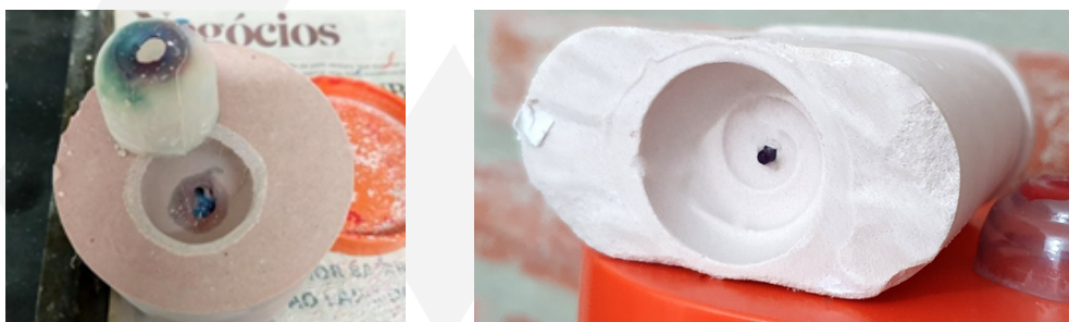
(Fig.10a) Cone removido, cera perdida; (Fig.10b) Prototipagem em resina calcinável.
