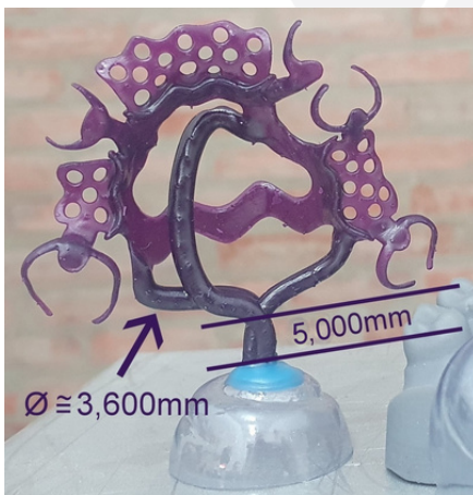
(Fig.8a) Prototipagem em resina calcinável projetada para fundição na vertical; (Fig.8b) União do cone com os canais de alimentação lisa, sem irregularidades.
