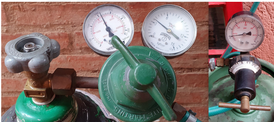
(Fig.15a) Manômetro no cilindro do oxigênio, um relógio regula a pressão do gás e o outro indica a quantidade de gás dentro do cilindro. (Fig.15b) Manômetro para o gás GLP regula a pressão.
