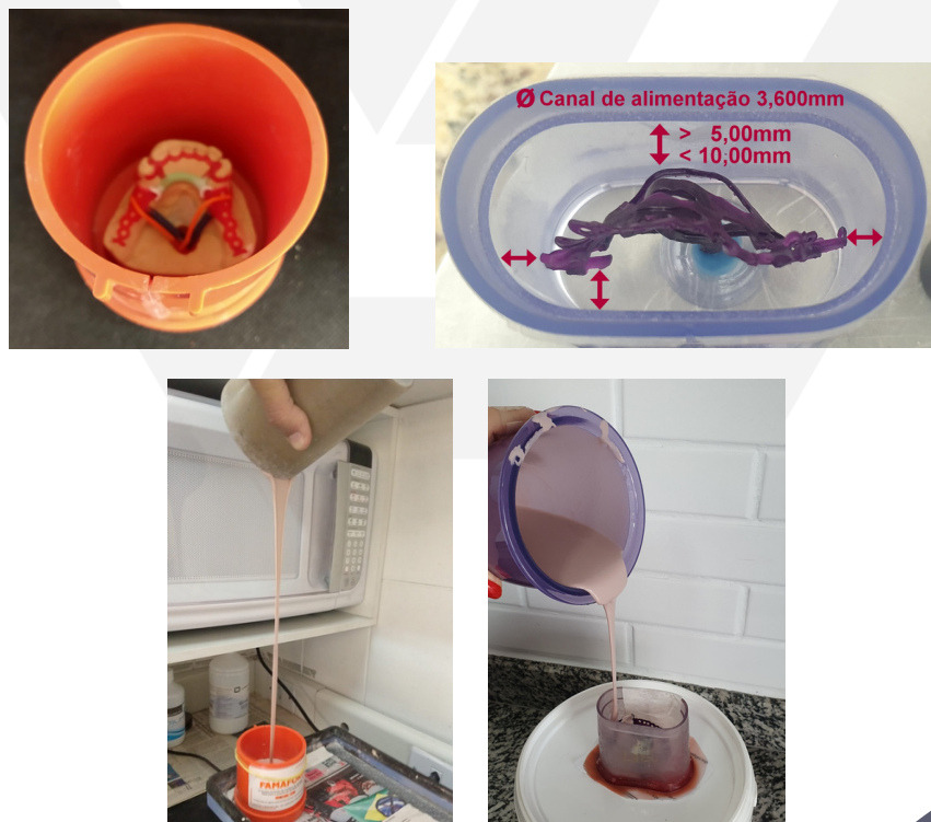
(Fig.9a) Modelo preparado para inclusão; (Fig.9b) Prototipagem preparada para inclusão; (Fig.9c e 9d) Anéis sendo incluídos para fundição.
