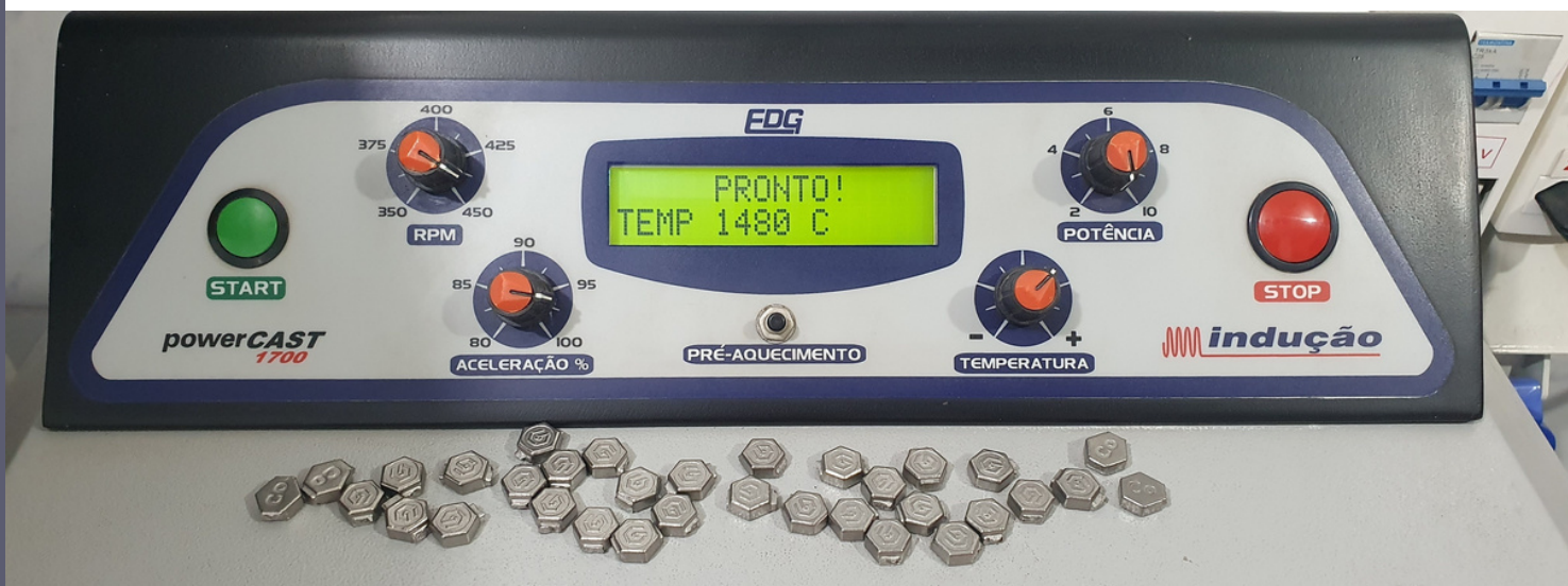
( Fig.19) Centrífuga por indução Power Cast 1700 EDG (regulagem indicada para este modelo) Temperatura 1.480° Celsius; RPM 450; Aceleração 100; Potência de 9 a 10; Regulagem do braço da centrífuga de acordo com o peso do anel.
