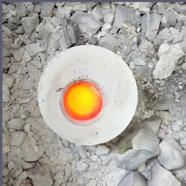
(Fig.17) Sucesso na fundição do G500, observado pelo formato do cone côncavo.
