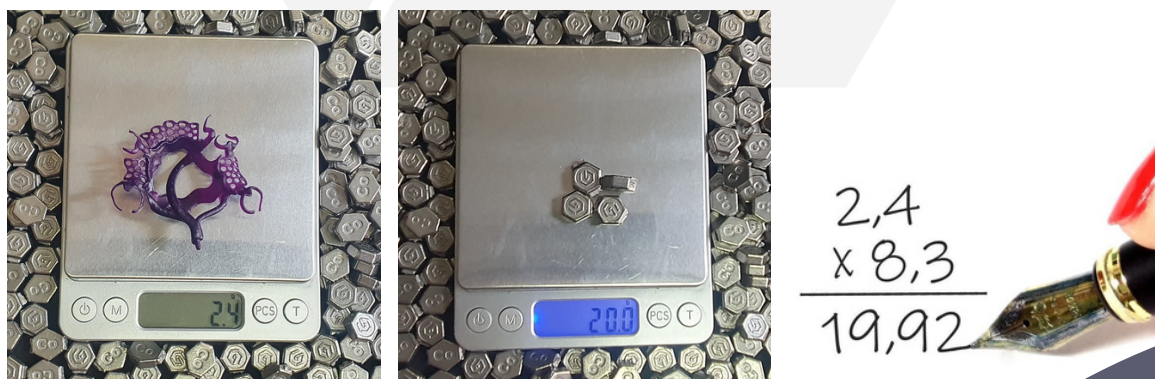
(Fig.4) Prototipagem em resina calcinável sendo pesada, cálculo do G500 necessário para a fundição.
