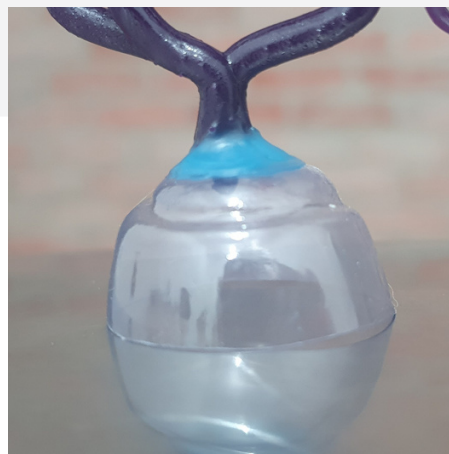
(Fig.8a) Prototipagem em resina calcinável projetada para fundição na vertical; (Fig.8b) União do cone com os canais de alimentação lisa, sem irregularidades.
