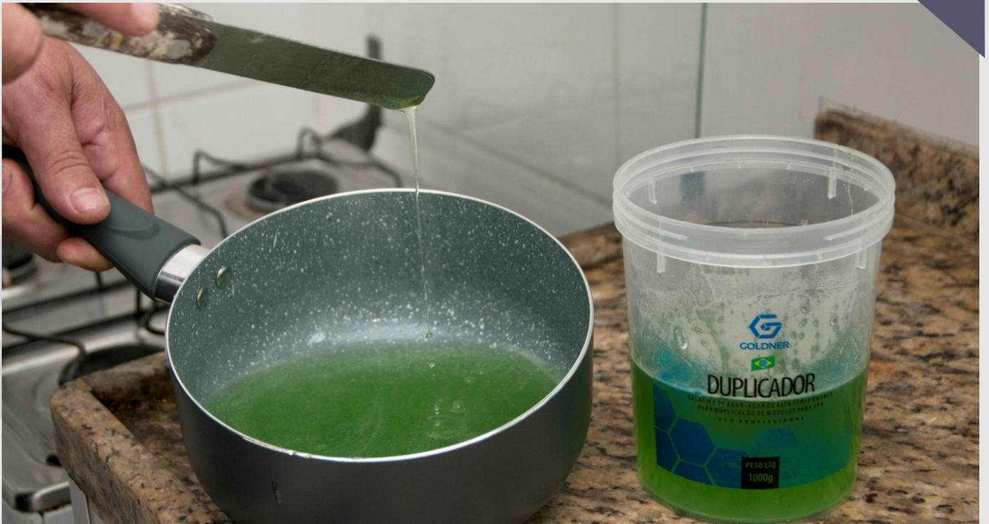
■ Atingir o ponto de fusão a 90°C formando uma camada de espuma, esta espuma desaparece a medida que o hidrocoloide esfria.
