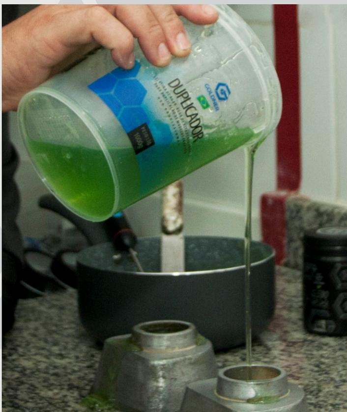
■ Verter o duplicador GOLDNER na mufla, lentamente, de uma altura de 30 cm, criando um fio regular de 3mm de diâmetro. **Não verter o hidrocoloide diretamente sobre a cera, pode deformá-la. Não vibrar.**
